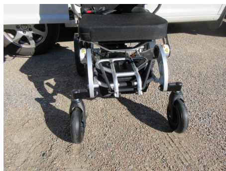
Här är fotsteget i läget för hopfällning av stolen.
