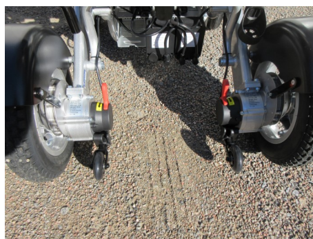
De röda spakarna frikopplar motorerna, då är den som en vanlig rullstol
