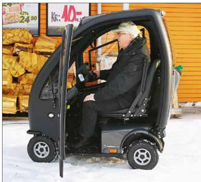
Konsumentprodukter och hjälpmedel närmar sig varandra. Elbil för en person och elektrisk rullstol med kabin. Mini Crosser Kabin, är en medicinteknisk produkt som kan anpassas individuellt efter behov.
