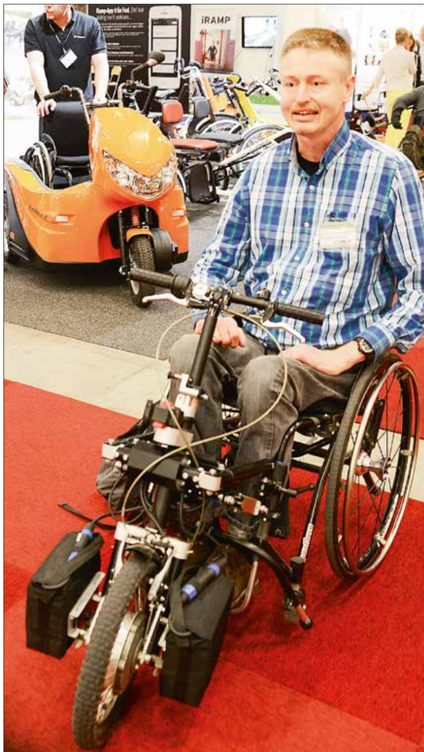
Johan Gunnarson med egenkonstruerad påhängsmotor till manuell rullstol.
